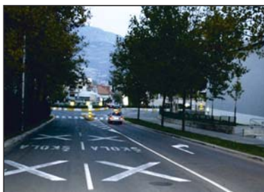
Slike 26. - 30. Malo kružno raskrižje kao mjera za smirivanje prometa, izvedeno u Splitu kod OŠ Ravne Njive od montažnih elemenata uz odgovarajuće okomite i vodoravne prometne znakove
